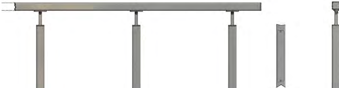
Anschlussstür im Pfosten
